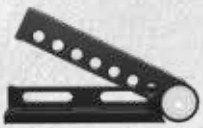
Стр. 219 Универсальный угольник с гидромеханическим зажимом
